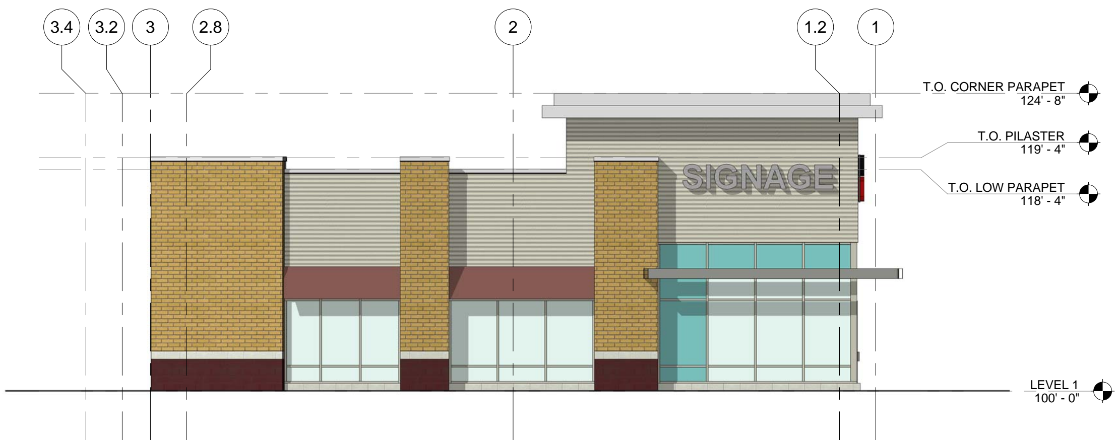
A3 EAST EXTERIOR ELEVATION 1/8" = 1'-0"
